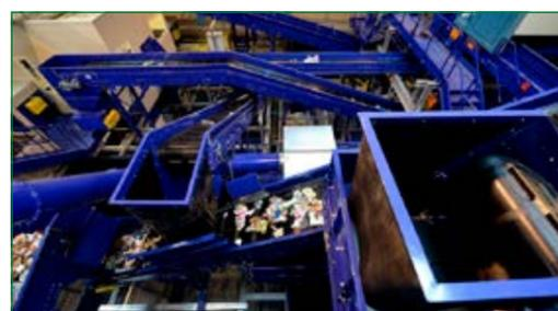
3 Différentes techniques permettent de trier les déchets : tri mécanique, aimant (fer et acier), courant de Foucault (aluminium).
