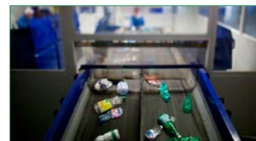
4 Le tri optique permet de séparer les différents plastiques (transparents, opaques).
