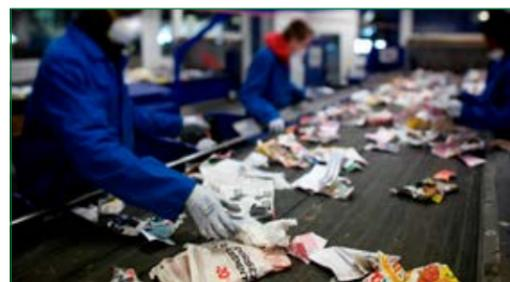
5 Un contrôle manuel permet de mettre à l'écart les éléments perturbateurs.
